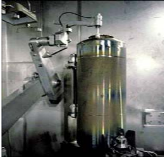
SOLDADURA DE CÁPSULA DE ALMACENAMIENTO
