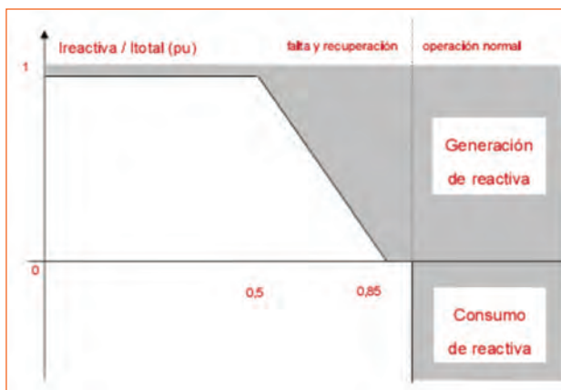
Figura 10: Consumo de reactiva ante un hueco de tensión. Fuente: Procedimiento de operación del sistema eléctrico 12.3.
